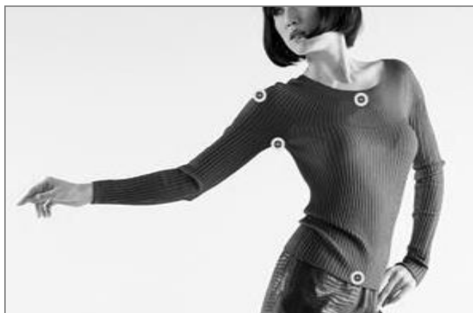
Figura 2 - Peça pronta sem costura fabricada com a tecnologia wholegarment
